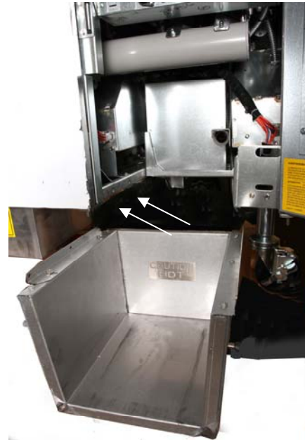
Εικόνα 1: Τοποθετήστε το melter στο ερμάριο και προσαρτήστε το με τις παρεχόμενες βίδες στο εσωτερικό του ερμαρίου.
